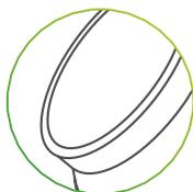
Las bocas están diseñadas para asegurar máxima estanqueidad. Doble junta simétrica que garantiza la estanqueidad del encaje del conducto con el equipo.
